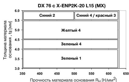
Точная настройка достигается в ходе монтажных испытаний на месте установки.
