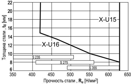
X-U 16 P8, X-U 15 P8TH: Для обшивки из листовой стали толщиной 0,75 мм  $\leq t_1 \leq 1,25$  мм
