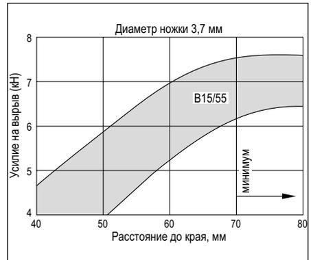
предотвращение сколов бетона и/или образования трещин, вызванных крепежным элементом. Тем не менее, растрескивание обычно оказывает лишь незначительное влияние на сопротивление крепления вырыву.
