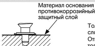
Толщина антикоррозионного защитного слоя материала основания  $\leq 0,4$  мм. Относительно слоев с повышенной толщиной проконсультируйтесь с Hilti.
