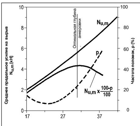
после которой суммарная эффективность крепления начинает уменьшаться. Это примерно 18-32 мм в зависимости от класса и возраста бетона, а также от прочности крепежного элемента.
