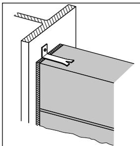
Крепление стали к стали, например, настенные закладные, распорки, профили
