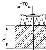
Сталь:  $t_{II} \geq 4$  мм
