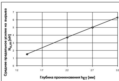
Увеличение глубины анкеровки с целью повышения прочности ограничивается увеличением числа поломок крепежных элементов. При одинаковой глубине анкеровки гвозди держатся лучше в бетоне большей прочности. Но использование этой особенности также ограничено более частыми разрушениями гвоздей в бетоне высокой прочности.
