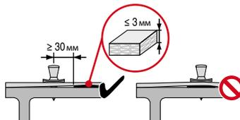
Чтобы обеспечить возможность прямого контакта между обшивкой из листовой стали и стальной опорой в зоне соединений, крепеж X-ENP-19 должен быть установлен на расстоянии  $\geq 30 \text{ мм}$  от края изоляции / изоляционной ленты, с толщиной не более 3 мм.
