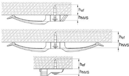
\*) Для X-ET MX измерение  $h_{NVS}$  выполняется по кабельному коробу.
