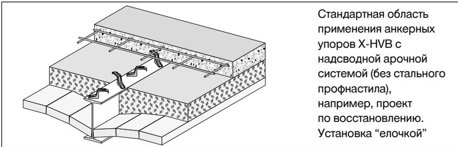
Стандартная область применения анкерных упоров X-HVB с надсводной арочной системой (без стального профнастила), например, проект по восстановлению. Установка “елочкой”
