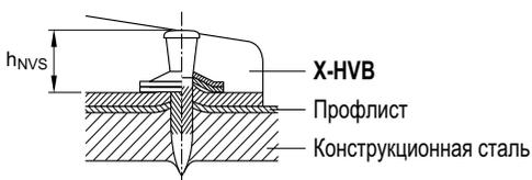
$$8.2 \text{ мм} \leq h_{NVS} \leq 9.8 \text{ мм}$$
