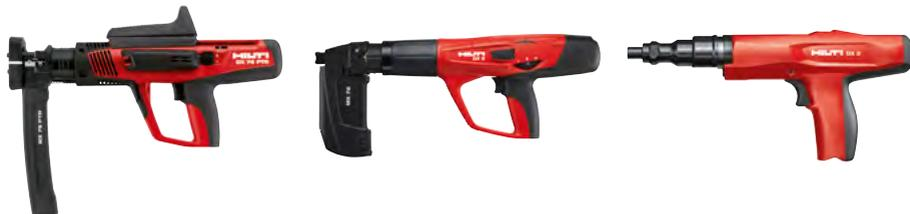
Эти инструменты в качестве источника энергии используют патроны с разным количеством пороха. При воспламенении, энергия пороха толкает поршень, который в свою очередь забивает дюбель-гвоздь в базовый материал.
