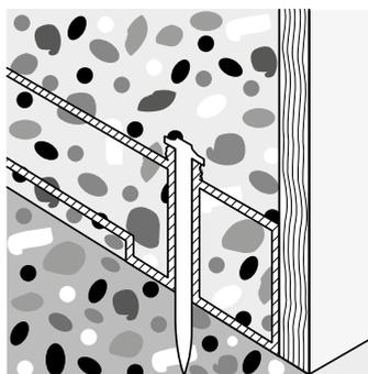
Расположение опалубки на бетонных поверхностях. Фиксатор бетонируется - полипропилен не ржавеет, почти не виден и не проводит ток.
