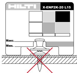
$h_{NVS} > 11 \text{ мм}$
