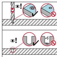
Сверлите до образования фаски вокруг отверстия. Просверленное отверстие должно быть очищено от мусора и жидкостей.
