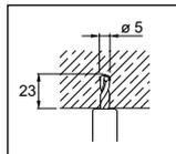
2. Для ДКН 48 предварительно просверлите отверстие ( $\varnothing 5 \times 23$ )
