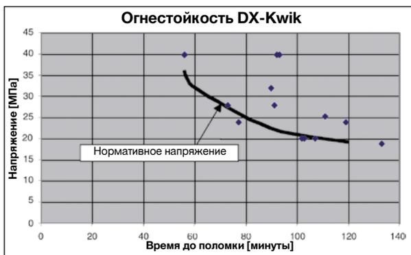
**Разрушающие нагрузки для различных диаметров ножки гвоздя и времени воздействия огня**
