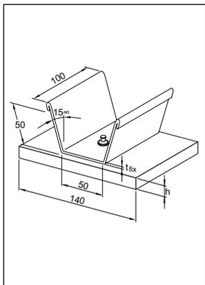
Образец для испытаний на растяжение
