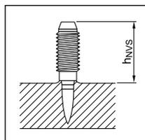
$h_{NVS} = 17-20 \text{ мм}$
