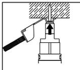
3. Установите гвоздь, прижмите инструмент, нажмите на спусковой крючок - готово
