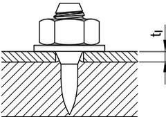
$$t_1 \leq L_g - t_{\text{шайбы}} - t_{\text{гайки}}$$
