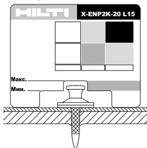
$h_{NVS} = 7-11 \text{ мм}$
