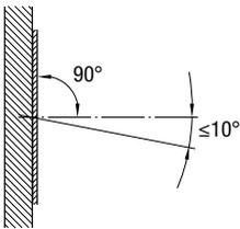
Расположите монтажный пистолет DX таким образом, чтобы отклонение гвоздя не превышало  $10^\circ$  от перпендикуляра к поверхности
