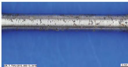
Высокочрезвычайностойкая сталь после использования в автомобильном тоннеле
