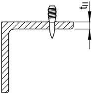
Минимальная толщина стали  $t_{II} \geq 6$  мм
