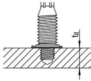
$t_{||} \geq 6 \text{ мм}$
