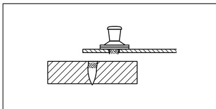
На практике такое разрушение случается только тогда, когда не предусмотрены компенсационные зазоры для перераспределения внутренних усилий из-за разницы температур.
