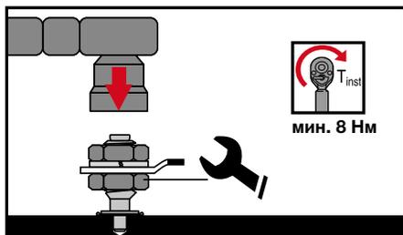
Удерживайте нижнюю гайку с помощью гаечного ключа, одновременно затягивая верхнюю гайку.
