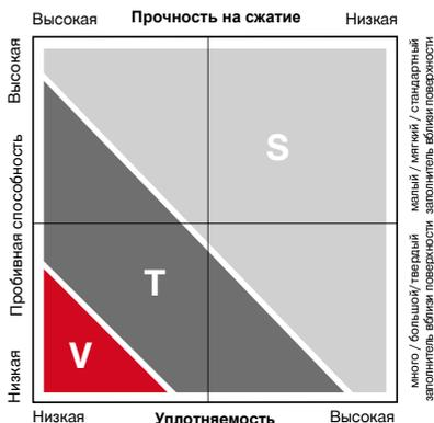
Примечание:  $R_{b,н}$  = предел прочности при сжатии для бетонного куба (длина грани 150 мм)
