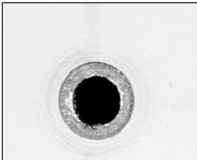
Засверлить ступенчатым сверлом TX-PGR-RU-4/10-93 (артикул 2061802), до образования фаски вокруг отверстия (для обеспечения надлежащей глубины высверленного отверстия).
