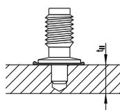
$t_{II} \geq 8$  мм
