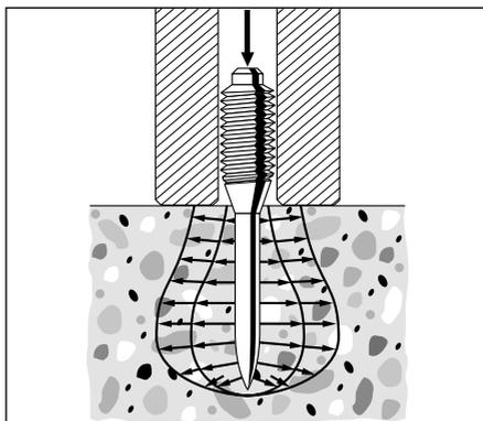
**Замена длинных крепежных элементов короткими снижает величину напряжения и, следовательно, частоту отказов при установке крепежных элементов.**
