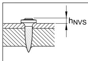
$h_{NVS} = 2.5-4.5 \text{ мм}$
