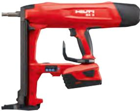
Данный инструмент не использует горючих расходных материалов. Ударный поршень приводится в действие электрическим мотором, двумя пружинами и ременной передачей. В качестве источника энергии достаточно 22-вольтовой батареи, которая полностью совместима с другими инструментами Hilti на платформе 22В.
