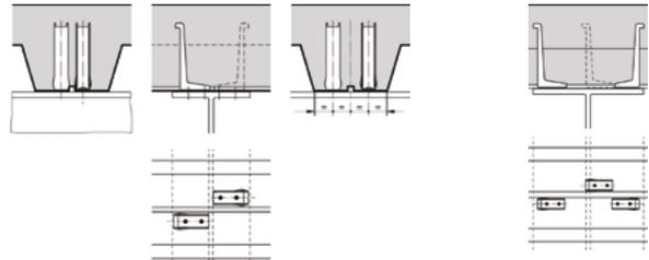
С касанием ребра жесткости
