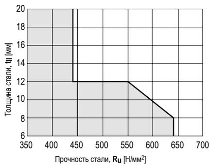
**X-ВТ:** Границы области применения отсутствуют → применение для высокопрочной стали ( $R_u$  до 1000 МПа)
