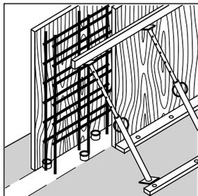
Фиксация бетонной опалубки на бетонных поверхностях. Оставить на месте, серый полиэтилен не ржавеет, почти не видим и не проводит ток.
