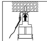
4. Установите гвоздь, прижмите инструмент, нажмите на спусковой крючок - готово
