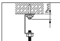
$h_{NVS} = 4-8 \text{ мм}$
