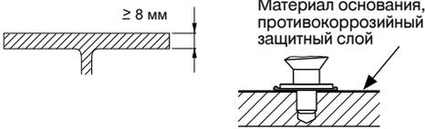
Толщина противокоррозионного защитного слоя материала основания  $\leq 0,4$  мм.
