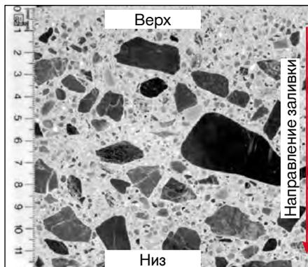
Более мягкие заполнители бетона, такие как известняк, песчаник или мрамор могут быть пройдены крепежным элементом полностью. Крепление в потолок, как правило, связано с более высокой частотой отказов, чем крепление в пол. Это связано с особенностями распределения компонентов бетонной смеси во время бетонирования. Крупные частицы имеют тенденцию оседать в нижней части бетонной плиты. В верхней же части концентрируются более мелкие частицы.
