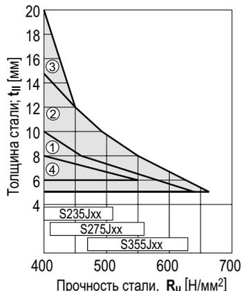
À **X-CR16** ( $t_1 \leq 3 \text{ мм}$ ) для пистолета DX 450
