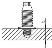
$t_{II} \geq 6$  мм
