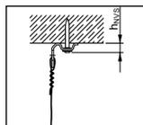
$h_{NVS} = 4-7 \text{ мм}$
