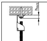
$h_{NVS} = 6-10 \text{ мм}$
