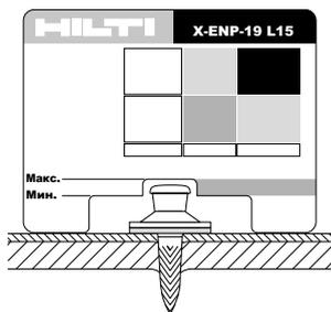
$h_{NVS} = 8,2-9,8 \text{ мм}$
