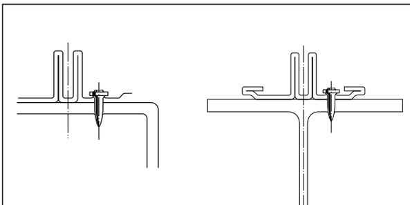
Установка профилей крепления стеклянных фасадов с помощью DX 450 (125%, 8 мм, для узких мест)
