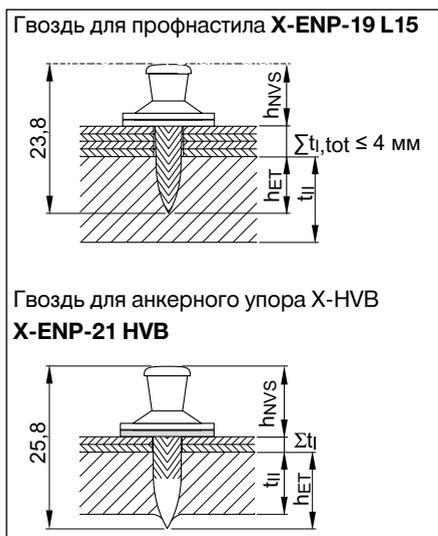
Ориентировочные значения глубины анкеровки отдельных видов крепежных элементов:
