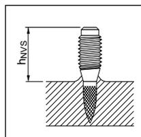
$h_{NVS} = 15.5-19.5 \text{ мм}$
