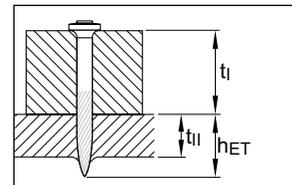
$h_{ET} \geq 8$  мм
