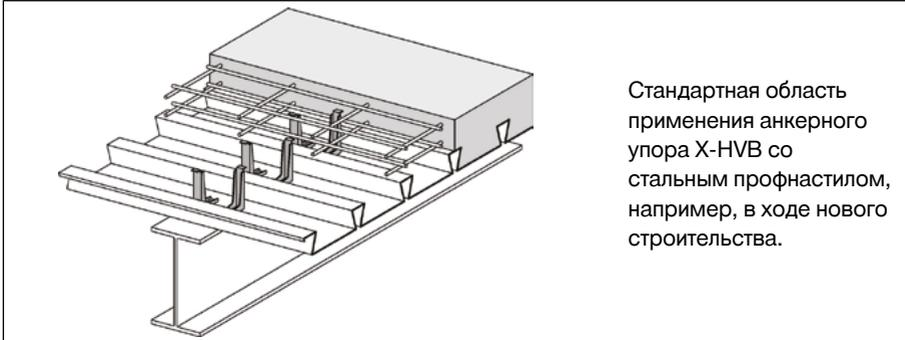
Стандартная область применения анкерного упора X-HVB со стальным профнастилом, например, в ходе нового строительства.
