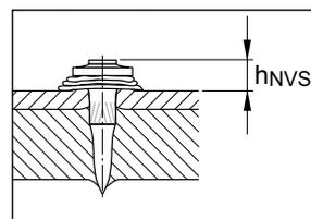
$h_{NVS} = 4.0-6.0 \text{ мм}$
