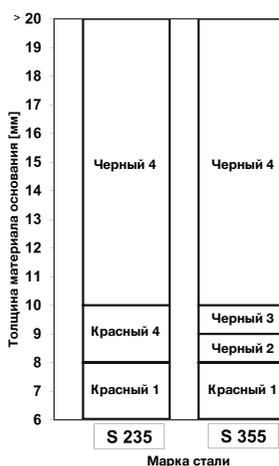
Для термомеханически катаной строительной стали, например S 355M согласно EN 10025-4, предельное значение применения уменьшено на 50 Н/мм<sup>2</sup>
