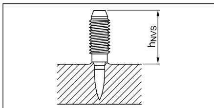
$h_{NVS} = 17.0 - 20.0 \text{ мм}$
