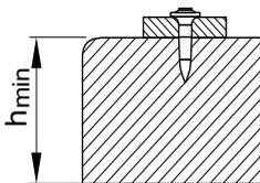
$$\text{Бетон: } h_{\min} = 80 \text{ мм}$$
