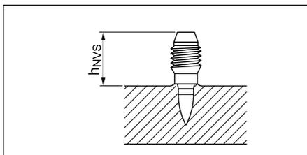
$h_{NVS} = 12.0 - 15.0 \text{ мм}$
