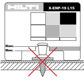
$h_{NVS} > 9,8 \text{ мм}$
