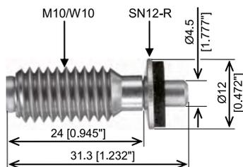
**Обозначения резьбовых шпилек X-BT, X-ST, S-BT**
