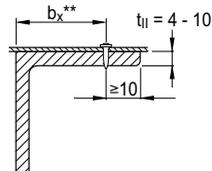
\*\* макс. допустимое значение  $b_x \leq 8 \times t_{II}$  (однако рекомендуется проведение испытаний на месте установки)
