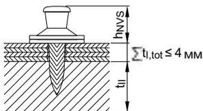
$h_{NVS} = 8,2-9,8 \text{ мм}$  для  $t_{i,tot} \leq 4 \text{ мм}$
