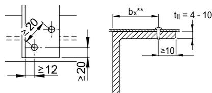
\*\* макс. допустимое значение  $b_x \leq 8 \times t_{II}$  (однако рекомендуется проведение испытаний на месте установки)
