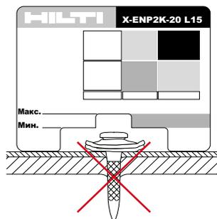
$h_{NVS} < 7 \text{ мм}$
