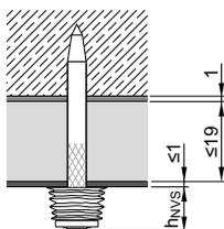
Деревянный брус:  $t \leq 27 \text{ мм}$  (условия: шляпка гвоздя утоплена вровень с поверхностью)
