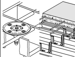
Некоторые дюбель-гвозди имеют специальные шайбы, необходимые для их основного применения, которые обеспечивают корректность крепления. Резьбовые дюбель-шпильки – особый вид дюбеля с верхней резьбовой частью вместо шляпки. Специальные крепежные элементы представляют собой сборку, состоящую из гвоздя и аксессуара, разработанного для конкретного применения, такого как зажим, пластина или крепежный диск из металла или пластика.
