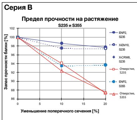
Графики соотношения числа установленных элементов и снижения несущей способности поперечного сечения показывают, что:
