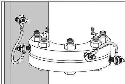
Рабочее и защитное уравнивание потенциалов для труб (**наружный диаметр поверхности базового материала  $\geq 150$  мм**)
