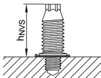
$h_{NVS} = 18.6 - 19.1 \text{ мм}$
