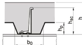
\*)  $b_o/h_p \geq 1.0$  для профлиста, ориентированного перпендикулярно балке в сочетании с X-HVB, ориентированных параллельно балке
