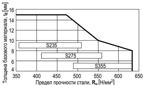
Область применения может увеличиться в случае решения специфических задач, например, крепления проволочной сетки к стали, которая соединена с помощью крепежных элементов X-CC U16 P8. Проволочная сетка служит армированием для напыляемого пожарозащитного покрытия. Обращайтесь в Hilti по вопросам применения X-CC U16 P8 в подобных особых условиях применения.
