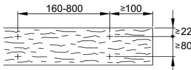
Расстояние между дюбель-гвоздями при монтаже дерева к бетону
