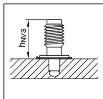
$h_{NVS} = 15.7-16.8 \text{ мм}$
