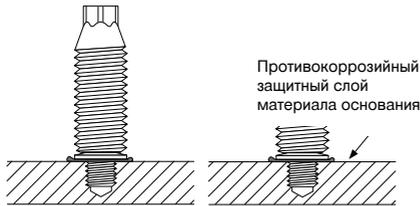
Толщина противокоррозийного защитного слоя материала основания  $\leq 0,8$  мм. При большей толщине покрытия проконсультируйтесь с Hilti.
