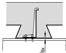
Максимальная общая толщина прикрепляемой листовой обшивки  $t_{fix}$ :
