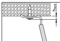
$h_{NVS} = 5.5-8.5 \text{ мм}$
