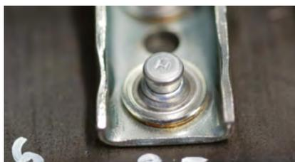
На поверхности шайбы виден четкий след от поршня
