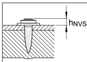
$h_{NVS} = 4.0-5.5 \text{ мм}$
