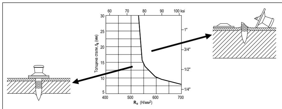
Граница области применения для **длинных гвоздей**, используемых для крепления **дерева к стали** является комбинацией длины ножки гвоздя  $L_{\text{st}}$  и толщины стали  $t_{\text{st}}$ . Каждая линия действительна только для одного предела прочности стали на растяжение  $R_{\text{st}}$ . Попытка использования в области справа от границы приведет к изгибу гвоздя.
