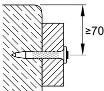
Краевые расстояния  $c \geq 70 \text{ мм}$
