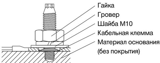
**Кабельное соединение типа В применяется только в конфигурациях с молниезащитой. Необходимо обеспечить соблюдение следующих требований:**
