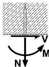
Примечание: В соответствующих случаях необходимо учесть возможность возникновения эффекта рычага (см. пример). Момент, действующий на ножку крепежного элемента, возникает только при наличии зазора между основанием и прикрепляемым материалом.
