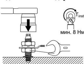
Удерживайте нижнюю гайку с помощью гаечного ключа, при этом затяните верхнюю гайку.
