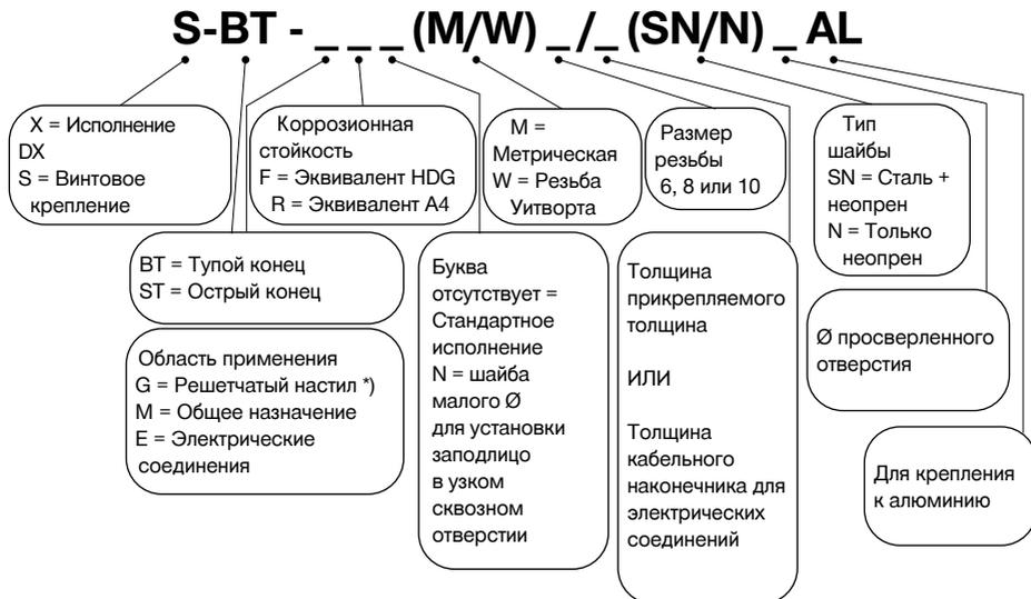
\*) Резьбовые шпильки из нержавеющей стали X-ST-GR могут также применяться в качестве универсального крепежа для различных областей применения.
