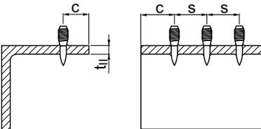
$$c, s \geq 15 \text{ мм}$$
