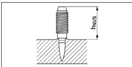
X-ST-GR M8/5 P8,  $h_{NVS} = 12.0 - 15.0 \text{ мм}$
