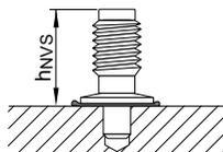
$h_{NVS} = 15.7 - 16.8 \text{ мм}$
