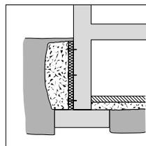
Временная установка изоляции влагонепроницаемых барьеров / дренажных пластин
