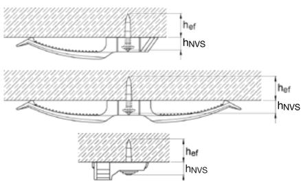
\*) В случае X-ET MX измерение  $h_{NVS}$  выполняется по кабельному коробу.
