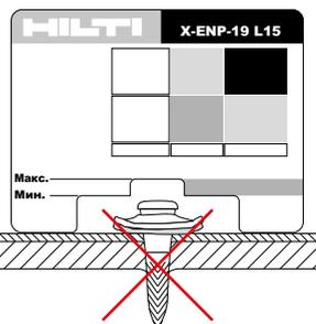
$h_{NVS} < 8,2 \text{ мм}$
