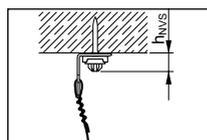
$h_{NVS} = 4-8 \text{ мм}$
