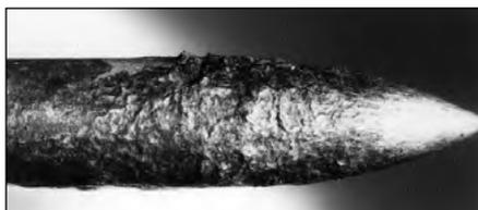
Механически очищенное острие вырванного гвоздя
