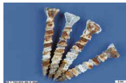
Рис. 14: Електрооцинковані гвинти з ~5 мкм цинкового покриття після 48 год (угорі) та 96 год (унизу) випробування в соляному тумані.
