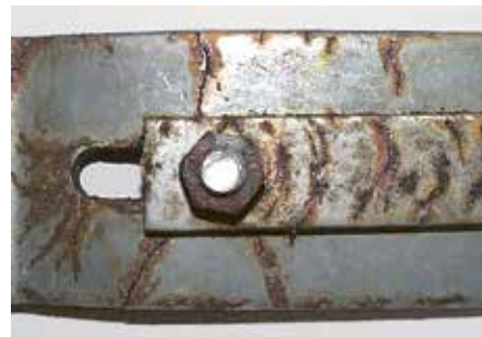
Рис. 8: SCC на кронштейні з матеріалу 1.4301 (A2, 304) після прибіл. 4 років експлуатації у критому басейні.
