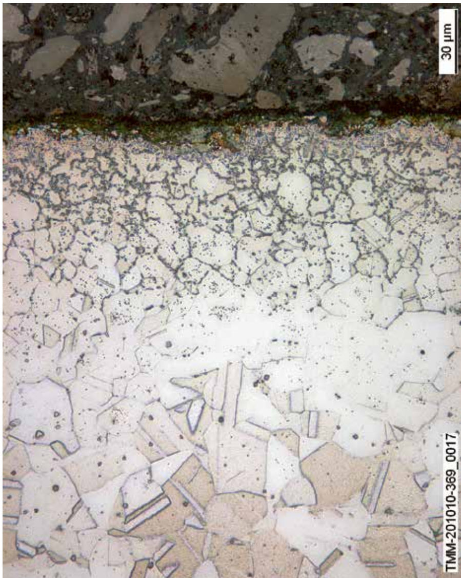
Рис. 11: Зображення зі сканувального електронного мікроскопа — вибіркове ураження в зоні зварного шва матеріалу 1.4401 (A4, 316).
