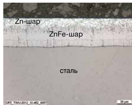
Рис. 30: Мікроструктура гарячеоцинкованої сталі
