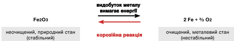
Рис. 1: Хімічні реакції заліза під час корозії та процесу добування металу.
