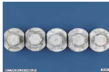
Рис. 19: Деталь з'єднувача з багатошаровим покриттям (верхній шар — органічні «пластівці») після 10 тижнів тесту ISO 20340 з УФ-опроміненням.
