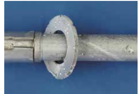
Рис. 5: Приклад точкової корозії на виробі з нержавіючої сталі.
