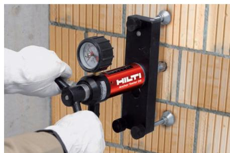
Для других полнотелых и пустотелых кирпичей, не описанных в Hilti HIT-HY 170 ETA и в настоящем руководстве по анкерному крепежу, предельную нагрузку можно определить с помощью испытаний на объекте (испытания на вырыв или испытания на рабочую нагрузку), в соответствии с ETAG 029, Приложением В.
